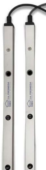
La Puerta Rápida Espiral FRESNEDA incorpora de serie una **cortina de fotocélulas de seguridad** que cubre toda la zona de paso. Este sistema permite una detección continua de personas, vehículos u objetos en el recorrido de la puerta, sin necesidad de contacto físico, deteniendo automáticamente su cierre si se detecta cualquier obstáculo.
